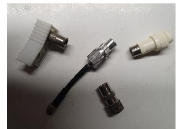
Figuur 4: Kalibratieset 75 ohm
