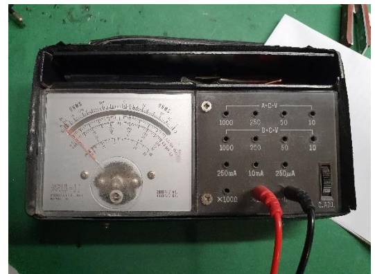
Figuur 2: Oude multimeter
