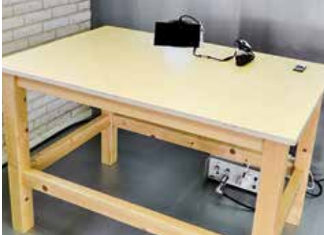
Fig. 2 De meetopstelling voor de geleidende emissie
