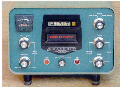
Afb. 1 De SB-630, een Heathkit bouwproject uit ongeveer 1970
